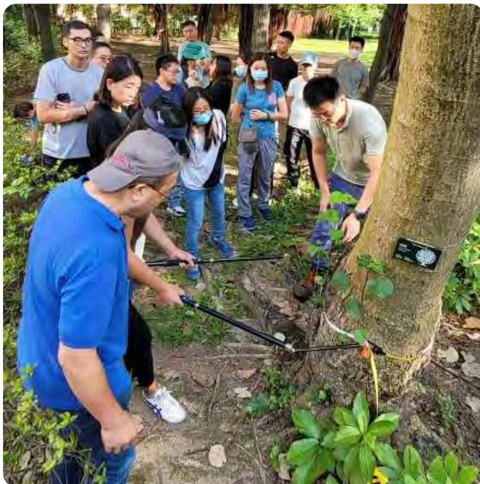
學員練習使用聲納探測儀檢查樹幹的內部狀況。
